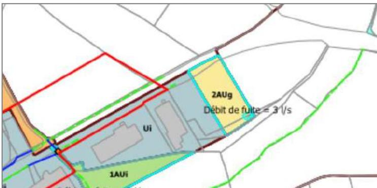
L'artificialisation des sols sur ce secteur nécessite la réalisation d'un ouvrage de rétention des eaux pluviales avant tout rejet dans le milieu. Il sera positionné au Sud-Est du terrain. Cet ouvrage est d'autant plus important qu'une zone humide est à proximité, à 32 m de la limite Sud.
